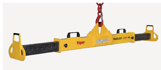
Fig. 19-2 Bilancino con gancio laterale con distanza tra i ganci regolabile
