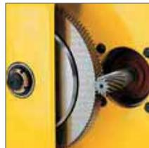
Getriebe mit Rutschkupplung
